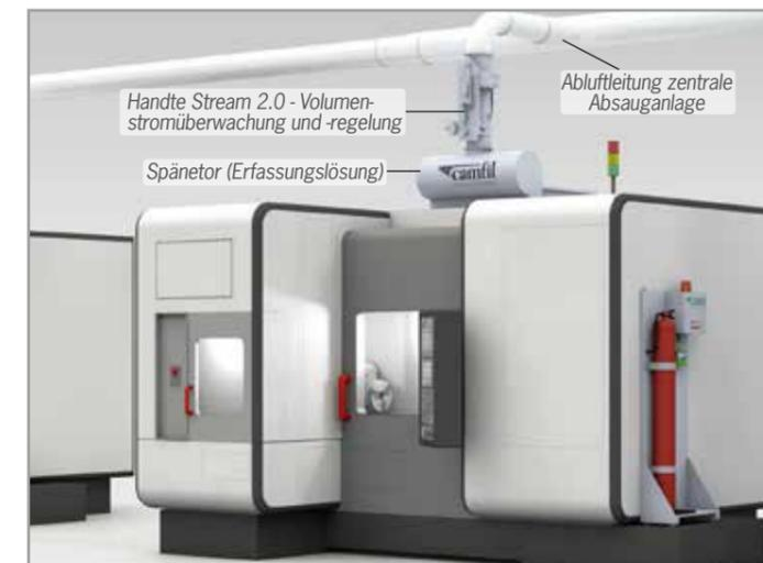
Ohne Umbauten oder komplizierte Schnittstellen-Modifikationen möglich: Einbaulagen waagrecht & senkrecht.
