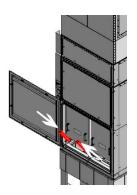
► Fold the clamping lever inward.
