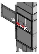
► Fold the clamping lever inward.
