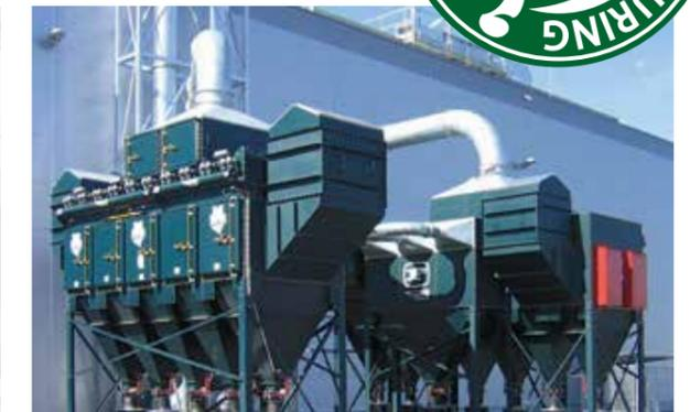
Anlage Thermisches Spritzen mit integriertem HEPA-Filter
