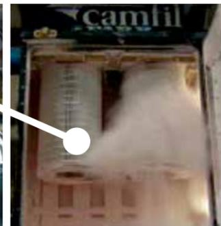
Impulsreinigung eines Gold Cone® Filters
