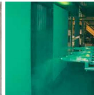
Die Gold Series Komponenten werden für optimale Korrosionsbeständigkeit alle einzeln pulverbeschichtet.
