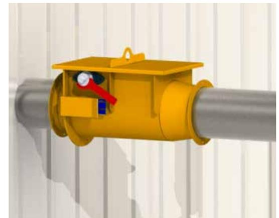
Ein selbstregulierender Verriegelungsmechanismus rastet ein, wenn das Ventil geschlossen wird und hält das Ventil während der Explosion geschlossen. Dieser Mechanismus wird bei der normalen Abschaltung des Anlagegebläses nicht betätigt.
