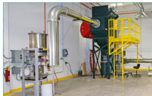
Teststand zur Staubprüfung nach ASHRAE-Norm 199
