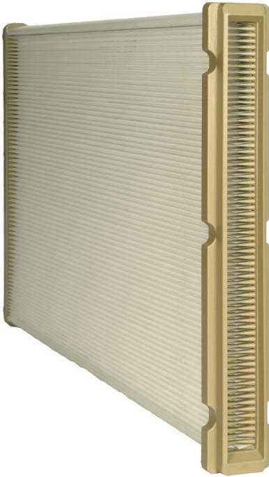
Die Filterplatten für den MF-Trockenfilter werden mit dem bewährten Dura-Pleat Filtermedium (Spinnvlies-Polyester) gefertigt und überzeugen durch ihren geringen Druckverlust, lange Standzeiten und eine hohe Abscheideeffizienz. Die Basis der Filterelemente ist ein Polyestermedium, das je nach Behandlung antistatische oder öl- und wasserabweisende Eigenschaften besitzt. Auch klebrige Stäube können mit Dura-Pleat Filtermedien gehandhabt werden.
